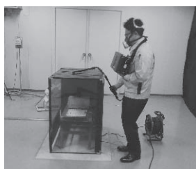
ポータブル型 火災予兆センサによる感知
